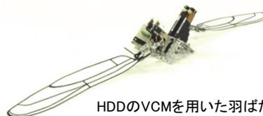
HDDのVCMを用いた羽ばたきロボット
