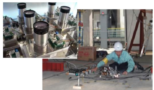
試作層間変位センサと実建物の地震応答計測実験
