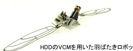
HDDのVCMを用いた羽ばたきロボット
